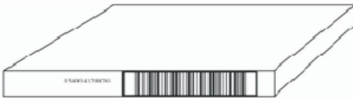
Слика 6-9 Бар кодови на плитки подметнувачи и кутии
