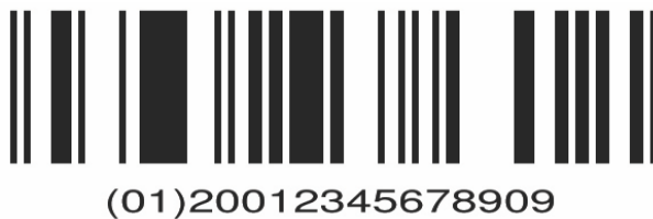
Слика 2-4 GS1 DataBar омнидирекционален
