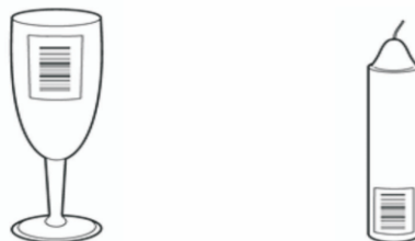
Слика 6-5 Примери за означување на цилиндрични површини
